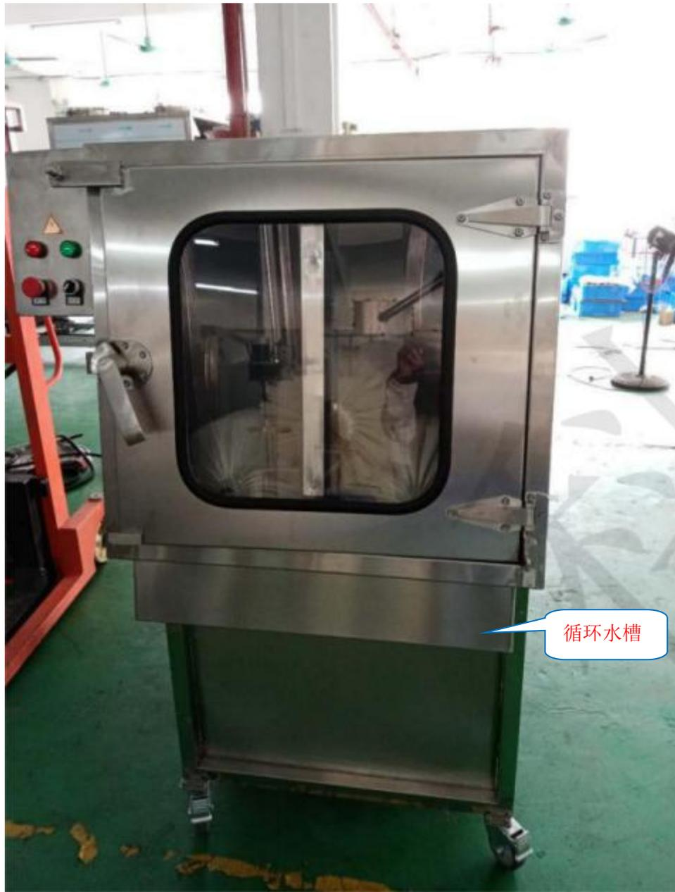
图 2-6 30L~120L 包装桶清洗设备示意图
